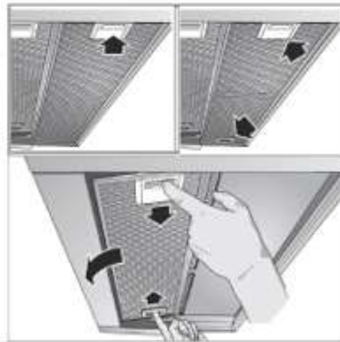
verwijderen van de filters
